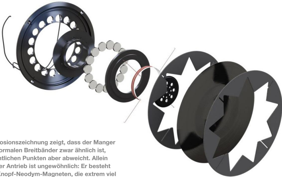
Die Explosionszeichnung zeigt, dass der Manger einem normalen Breitbänder zwar ähnlich ist, in wesentlichen Punkten aber abweicht. Allein schon der Antrieb ist ungewöhnlich: Er besteht aus 15 Knopf-Neodym-Magneten, die extrem viel Energie an die beiden Schwingspulen bringen (Foto: Manger Audio)
