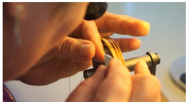
Die vier, nur 0.1mm feinen Schwingspulen-Zuleitungen auf der Vorderseite der Membran sind aus reinem Kupfer und werden – wie sonst? – in Handarbeit mit den Wicklungen der beiden 0,4 Gramm leichten Aluminiumschwingspulen verlötet (Foto: Manger)
