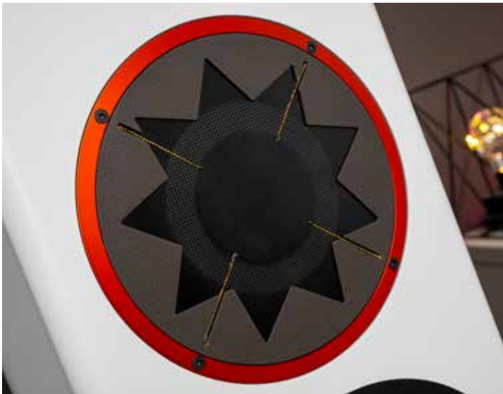
Der Biegewellenwandler, der jeden Lautsprecher von Manger zielt, ist natürlich auch bei der s1 mit seiner stellaren Anmutung der Blickfang und auch der akustische Star: Als Breitbänder übernimmt agiert er den großen Frequenzbereich von 330 Hertz bis 40 Kiloherz.
