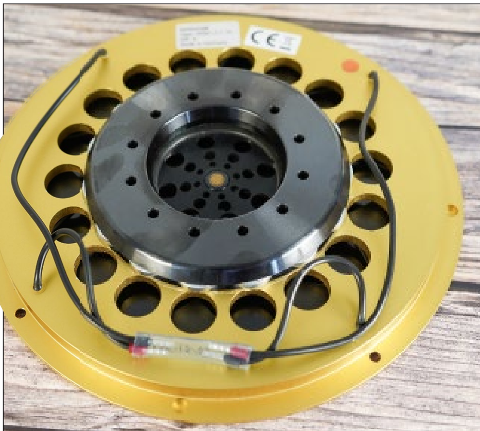
Der Wandler von der Rückseite aus betrachtet. Mittig sieht man die Bedämpfung der Membran.
