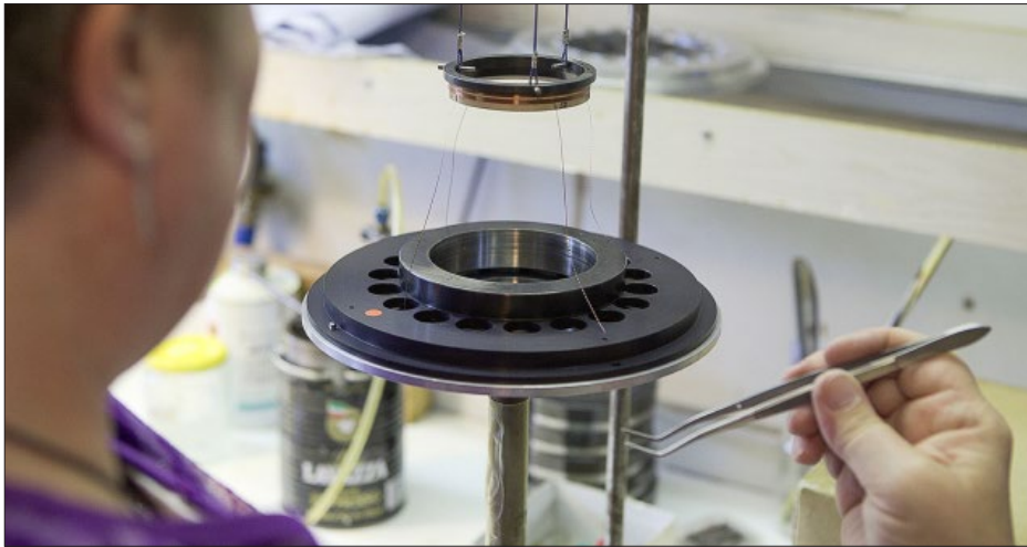
Die doppelte Schwingspule ist eines der wichtigsten Elemente des MSW. Die Montage verlangt ein gutes Auge und eine ruhige Hand.
