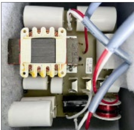
Die Frequenzweiche ist mit hochwertigen Bauteilen von Mundorf bestückt.
