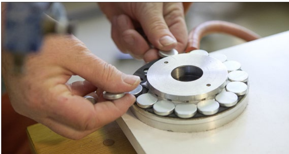
Die Bestückung mit den Neodymmagneten erfolgt wie der gesamte Zusammenbau des Manger-Wandlers von Hand.
