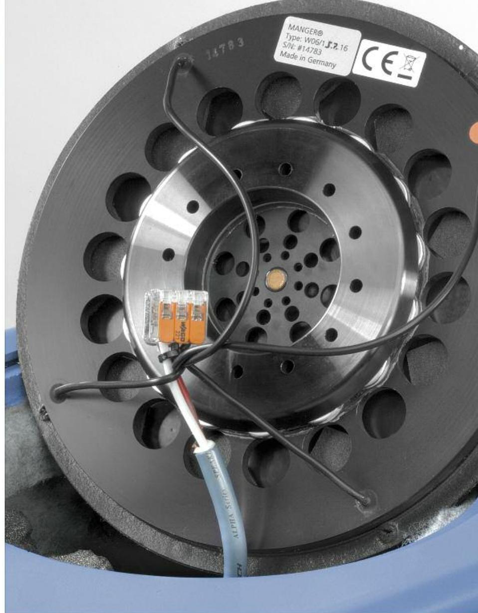
Oben links eine Detailansicht des Magnetsystems, bei der ein paar der insgesamt 15 Neodymium-Rondelle gut erkennbar sind. Das Magnetsystem wurde von seiner Geometrie her optimiert, damit der Magnetfluss mit geringsten Verlusten zum Luftspalt gelangt. Die Schwingspule selbst erreicht durch das stärkere Magnetfeld eine schnellere Anstiegszeit. Im Hörtest machte sich das durch die extrem feine Auflösung im Hochtonbereich bemerkbar
