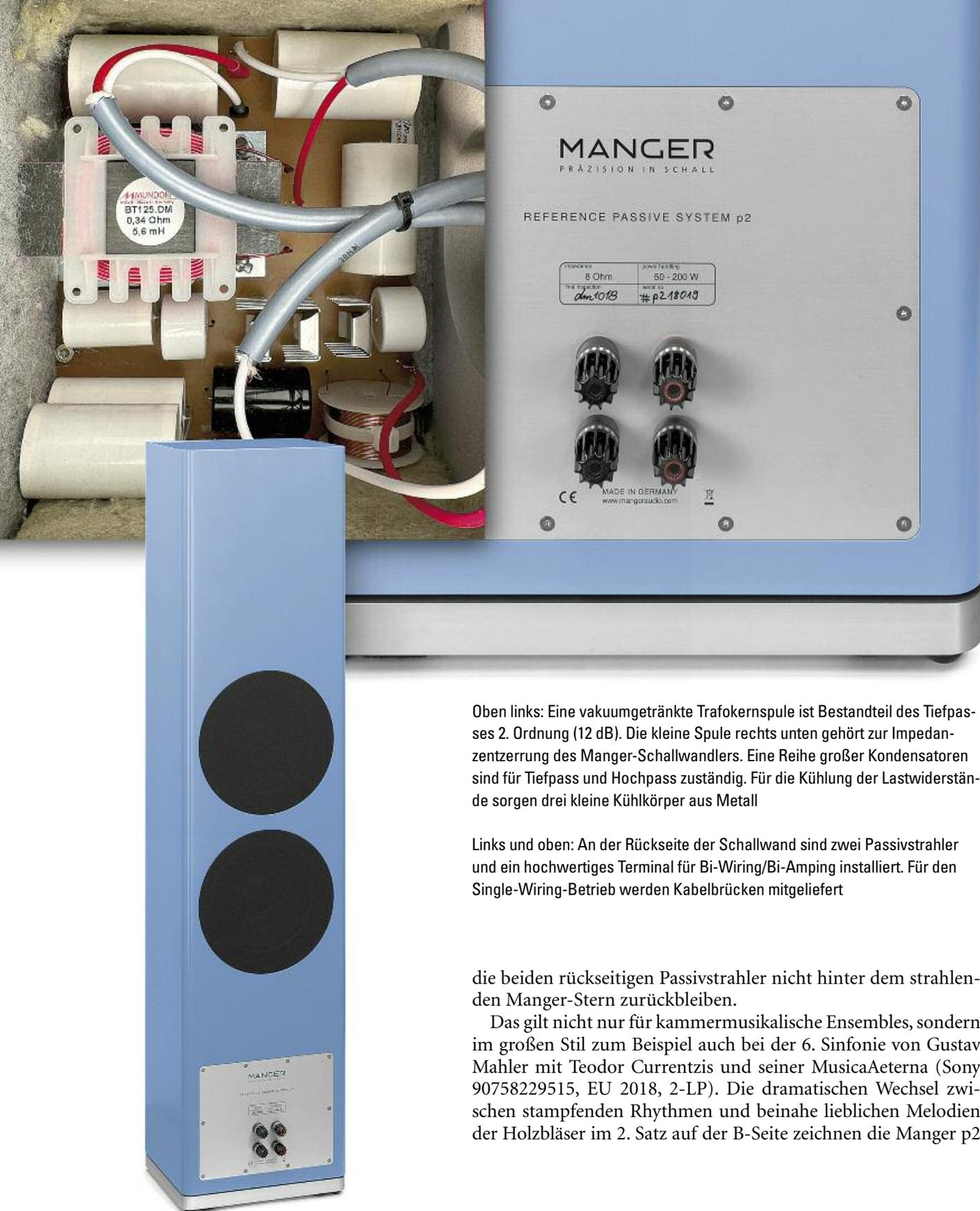
Oben links: Eine vakuumgetränkte Trafokernspule ist Bestandteil des Tiefpasses 2. Ordnung (12 dB). Die kleine Spule rechts unten gehört zur Impedanzentzerrung des Manger-Schallwandlers. Eine Reihe großer Kondensatoren sind für Tiefpass und Hochpass zuständig. Für die Kühlung der Lastwiderstände sorgen drei kleine Kühlkörper aus Metall
