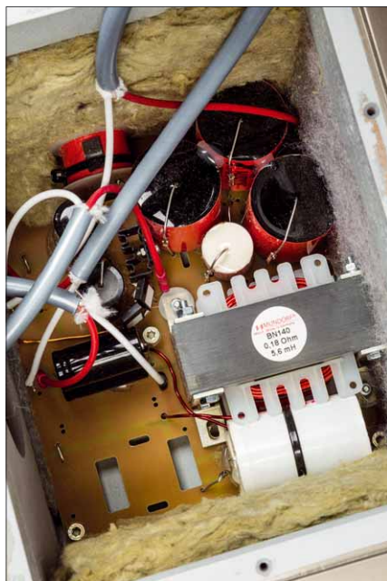
Die Frequenzweiche ist durchweg mit hochwertigen Bauteilen aufgebaut
