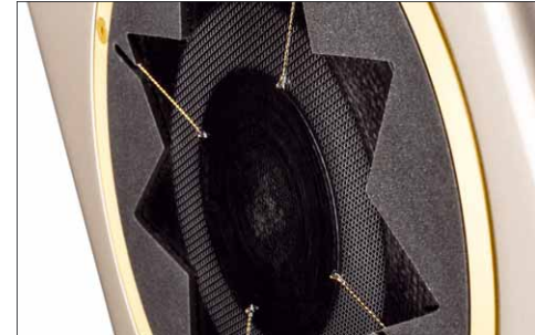
Der Manger-Wandler lebt davon, dass bei unterschiedlichen Frequenzen verschiedene Bereiche der Membran schwingen
