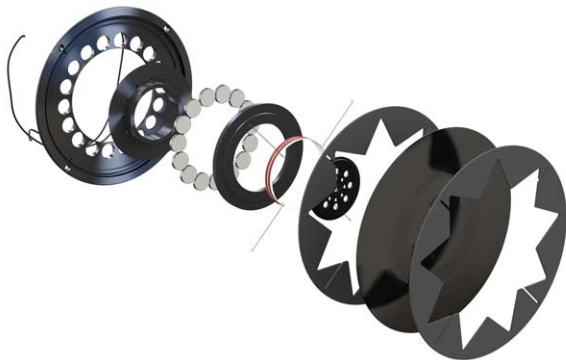
Der Manger-Schallwandler in der Explosionszeichnung
