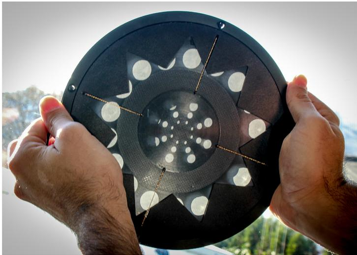
*Wenn man den BiegeWellen-Wandler gegen das Licht hält, kann man erahnen, wie hauchdünn seine schwarze Membran ist: Sie misst gerade mal 390 Mikrometer.*
