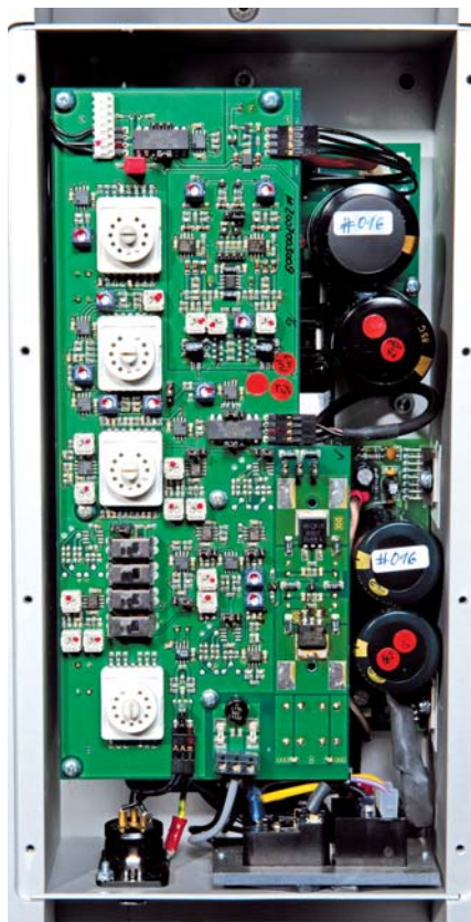
La face arrière de la Manger (à gauche) propose différents réglages accessibles par commutateurs rotatifs et à glissière qu'on aperçoit sur la gauche du circuit imprimé interne.
