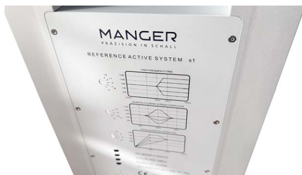
Auch ohne DSP flexibel – die Manger S1 lässt sich mittels Filtereinstellungen auf den Raum beziehungsweise den Hörgeschmack abstimmen
