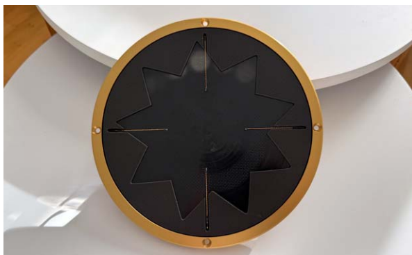
Typisch – die Sternform des Manger-Biegewellenwandlers
