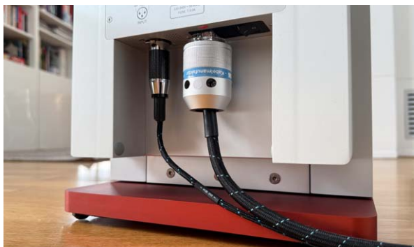
Übersichtlich – Das Signal wird der Manger S1 über ein analoges XLR-Kabel zugeführt, andere Möglichkeiten sind nicht vorgesehen. Wir haben im Test Kabel von WSS verwendet, was sich als gute Wahl erwies
