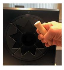
Setzen Sie das Ausbauwerkzeug oder den Korkenzieher im Schraubenloch gegenüber der verbliebenen Schraube an und verkanten ihn leicht. Sie müssen nun langsam und gleichmäßig ziehen, damit sich das Dichtband hinter dem Schallwandler langsam vom Gehäuse löst. Das kann einige Zeit dauern.
