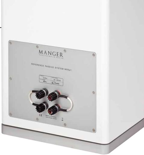
Das extrem solide Terminal erlaubt auch den Bi-Wiring-Betrieb
