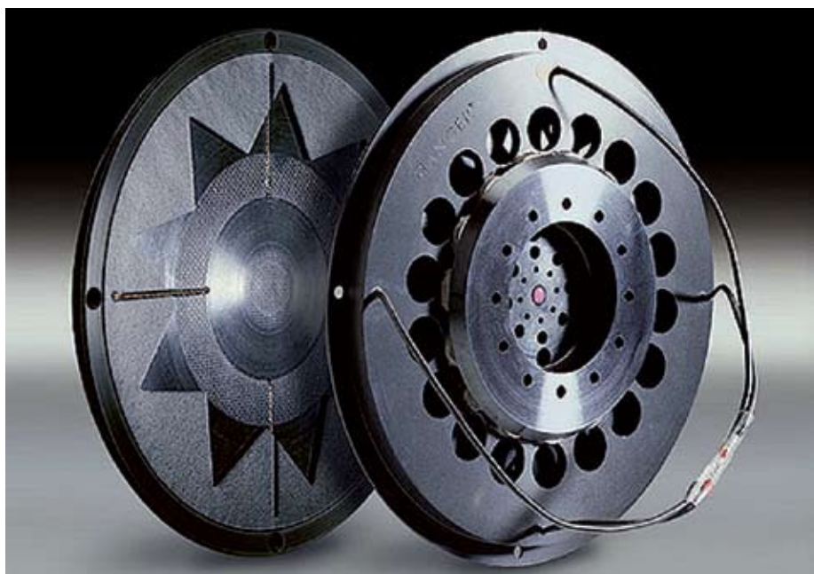
El transductor y guía de ondas MSW es el gran responsable de la innovación de los sistemas Manger. Se basa en el principio “bending wave”, donde las ondas sonoras se transmiten desde el centro hacia la periferia de la membrana, con una velocidad variable proporcional a cada frecuencia. Como puede verse, esto no tiene nada que ver con el tradicional movimiento de “pistón” que emplean la mayoría de los transductores usados hoy en día
