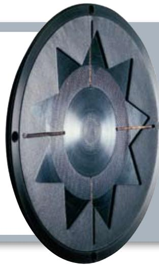
Die dünne, biege weiche Membran ist gänzlich flach. Die Steifigkeit ändert sich mit dem Radius und bewirkt eine mechanische Trennung. Höchste Töne werden mittig abgestrahlt, mittlere und tiefe Frequenzen weiter außen.
