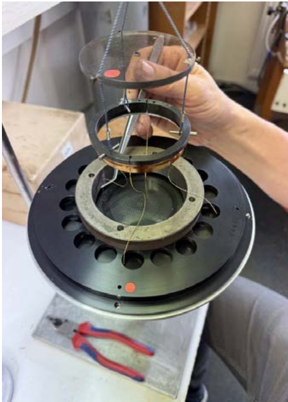
Es könnte auch ein Kinderspiel sein, das zur Konzentration zwingt: Die Leiter der Spule werden auf die Frontseite der Membran durchgesteckt
