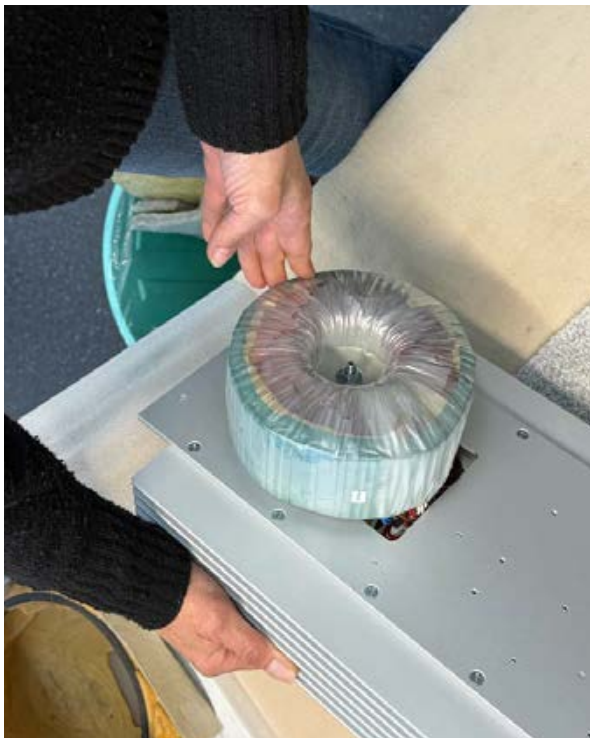
Alle wissen, wie wichtig eine stabile Stromversorgung ist. Deshalb verbaut Manger in seinen Aktiv-Modellen einen sehr stattlich dimensionierten Ringkerntrafo. Der auch den höchsten Anteil am Gesamtgewicht der Boxen ausmacht
