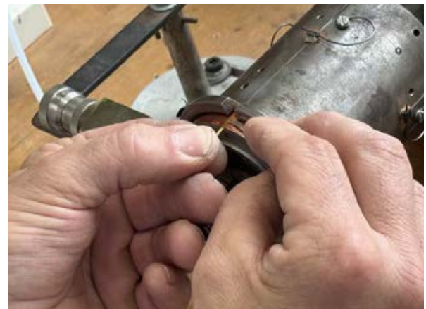
Filigran und feinfühlig: Die gewickelten Signalbahnen sind mit einem isolierenden Lack versehen. Der muss entfernt werden, bevor die Zuleitungen verlötet werden
