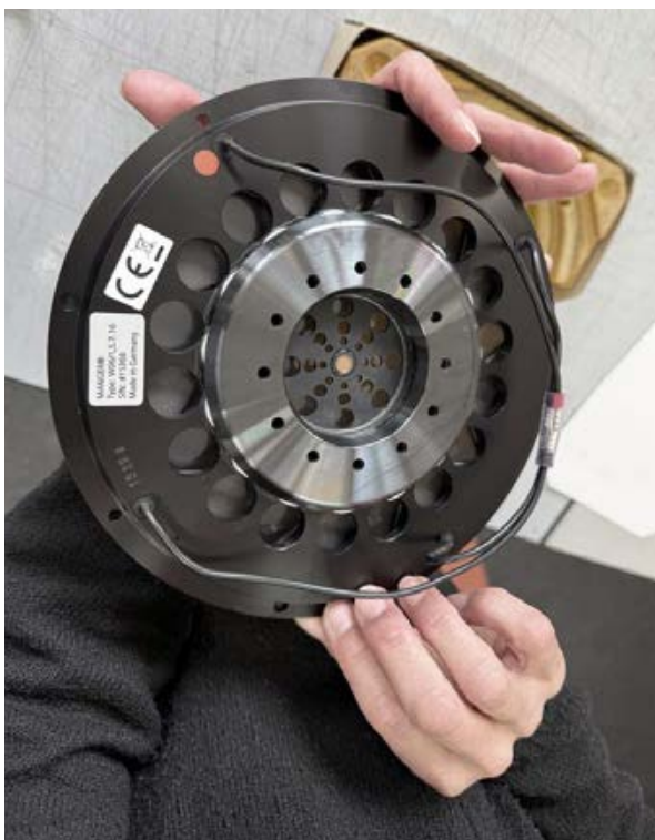
Fertig ist das gute Stück. Im Kranz hinter der Membran liegen knopfzellengroße Neodym-Magnete
