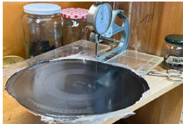
Es könnte auch eine Vinyl-Single sein. Die Membran entsteht inhouse, hier wird die korrekte Stärke vor der Weiterverarbeitung bestimmt
