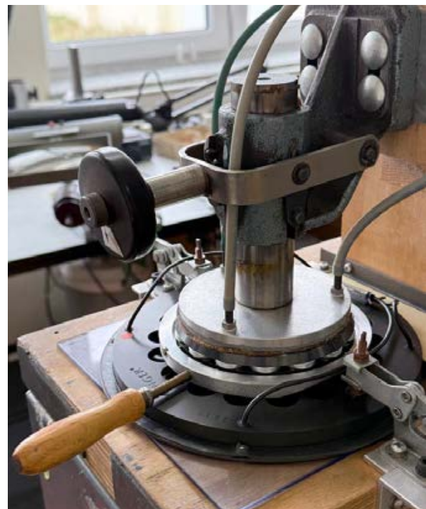
Jetzt wird gebacken: Das ist die Hochzeit von Membran und Antrieb. Gut zu sehen: die seitlich eingesetzten Neodym-Magnete
