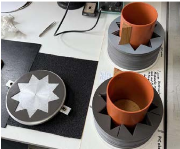
Dämpfung muss sein. Manger nutzt dazu eine Kunststofffläche, die passgenau ausgeschnitten und gestanzt wird. Über die Details zu Material und Klebstoff wird der Mantel des Schweigens gehüllt
