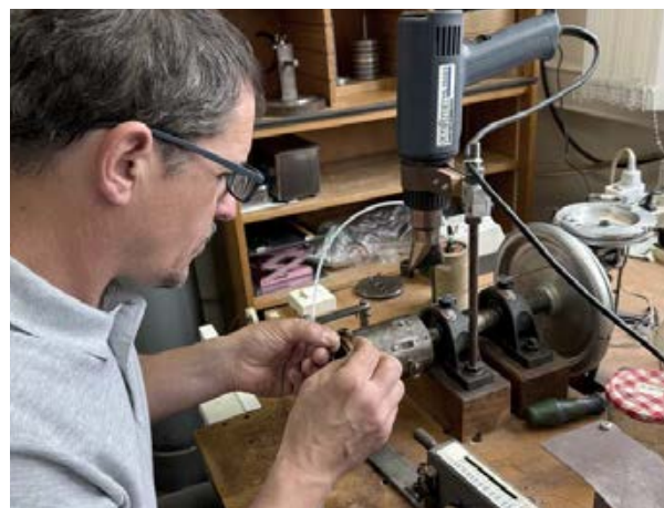
Viele der Maschinen hat noch der Firmengründer selbst ersonnen. Funktioniert bis heute. Ab und an muss die Heißluft-Pistole ausgetauscht werden. Der Motor für die Spulenwicklung läuft und läuft und läuft ...
