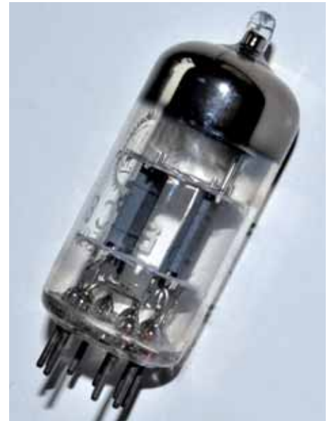
ECC81: zwei Trioden-Systeme in einem Kolben
