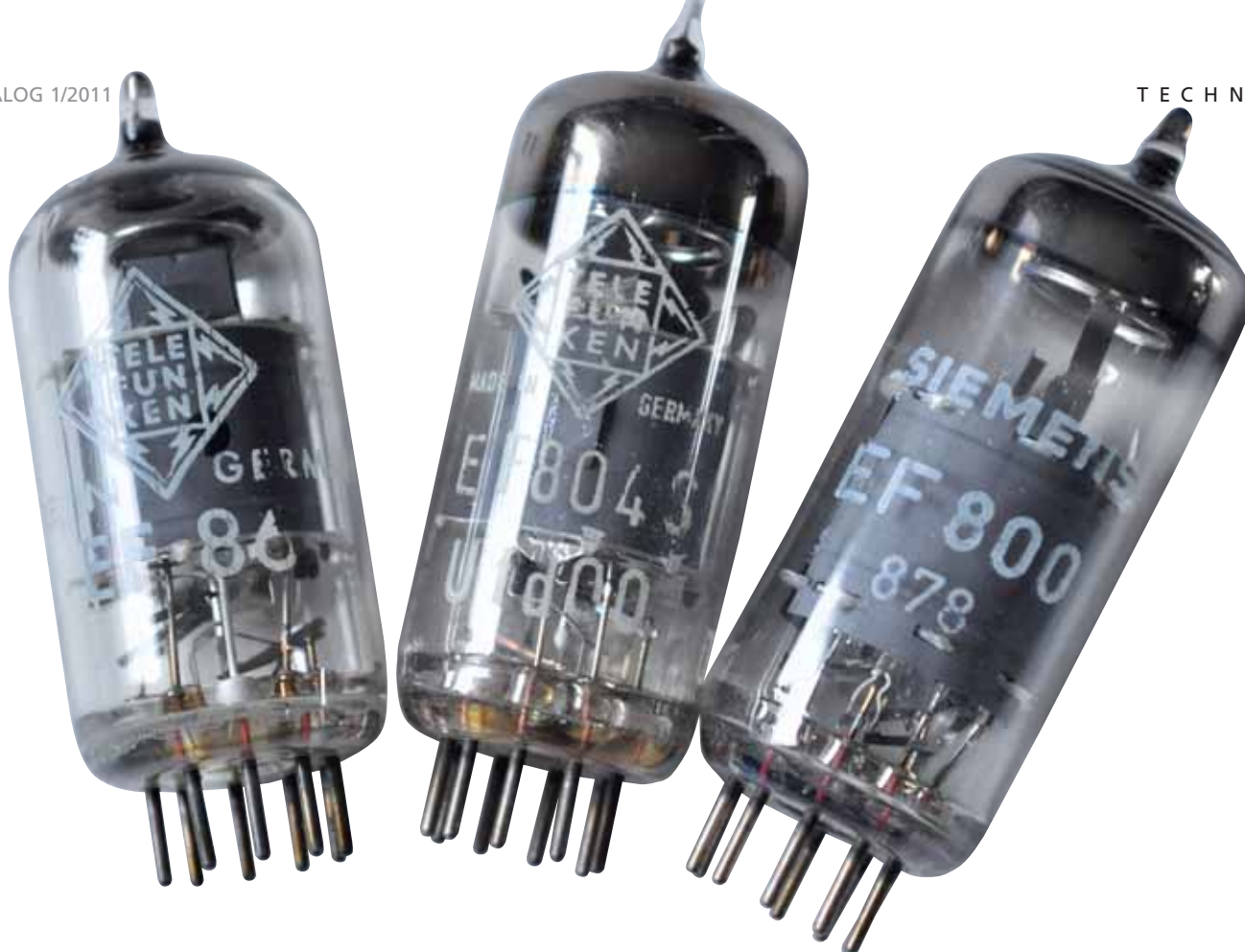
Sehr ähnliches Aussehen – aber völlig verschieden – Pentoden aus Studio-Verstärkern
