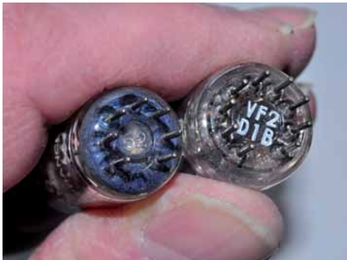
Die beiden häufigsten Röhrensockel
