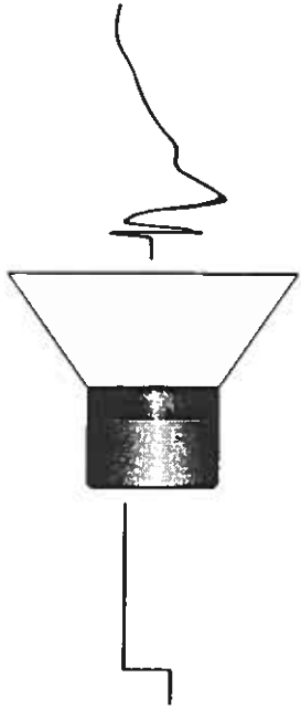
Darstellung des elektrischen Eingangssignals und des akustischen Ausgangs-/Drucksignals bei herkömmlichen Lautsprechern. – Ansatzpunkt für die MANGER'sche Forschungs- und Entwicklungsarbeit.
