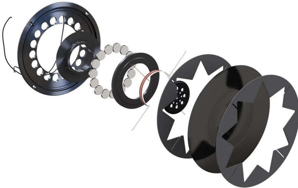
Explosionszeichnung des MSW: Gleich 15 kräftige Neodymium-Magneten sorgen im Luftspalt für eine hohe Flussdichte von 1,3 Tesla. Der Antrieb muss Prinzip-bedingt ohne Zentrierspinne auskommen, was eine ultrapräzise Fertigung erfordert (Foto: Manger Audio)
