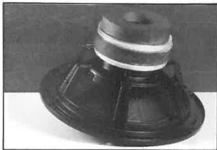
Vue de l'un des trois haut-parleurs de grave avec sa double ferrite
