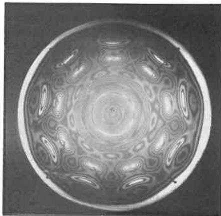
Hologramme montrant la dispersion des fréquences à la surface de la membrane du transducteur Manger à 800 Hz
