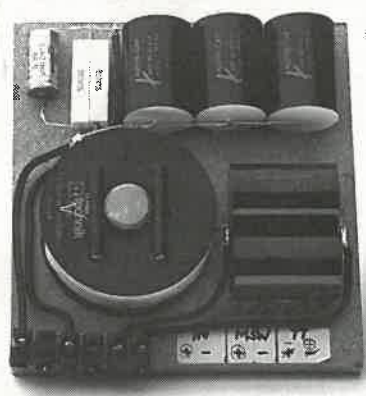
Die Frequenzweiche der Manger-Zerobox 105: Optisch dominieren die großen Folienkondensatoren. Durch Herausziehen des Corobarkerns aus der 12-Millihenry-Spule um 6 Millimeter ergibt sich die von Manger geforderte Induktivität von 11,4 Millihenry.
