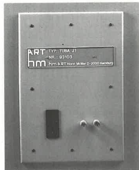
Auf dem Anschlußfeld der Tuba J1 irritiert der 230-Volt-Stromanschluß: Es handelt sich mitnichten um eine Aktivbox, sondern nur um die Stromversorgung der Horn-Innenbeleuchtung.
