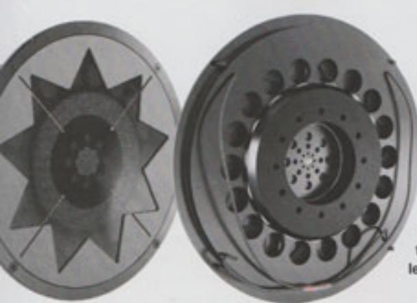
Det platta Manger-elementet ser inte ut som något annat högtalarelement. Det mjuka membranet dämpas mekaniskt av det stjärnformade yttermembranet. I den precisionsfrästa aluminiumkroppen döljs 15 neodymmagneter och två talspoler. Allt för att kontrollera membranrörelsen.
